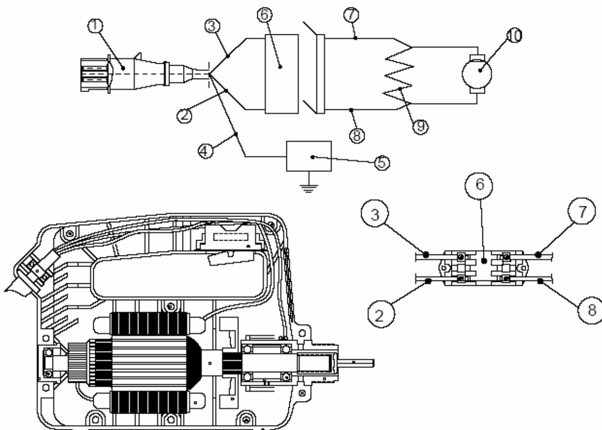
**Примечание:** Все кабели питания должны быть уложены в соответствующие углубления пластмассового корпуса, прежде чем будут соединены две его половинки.
