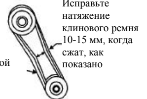
Рисунок 2. Натяжение клинового ремня
